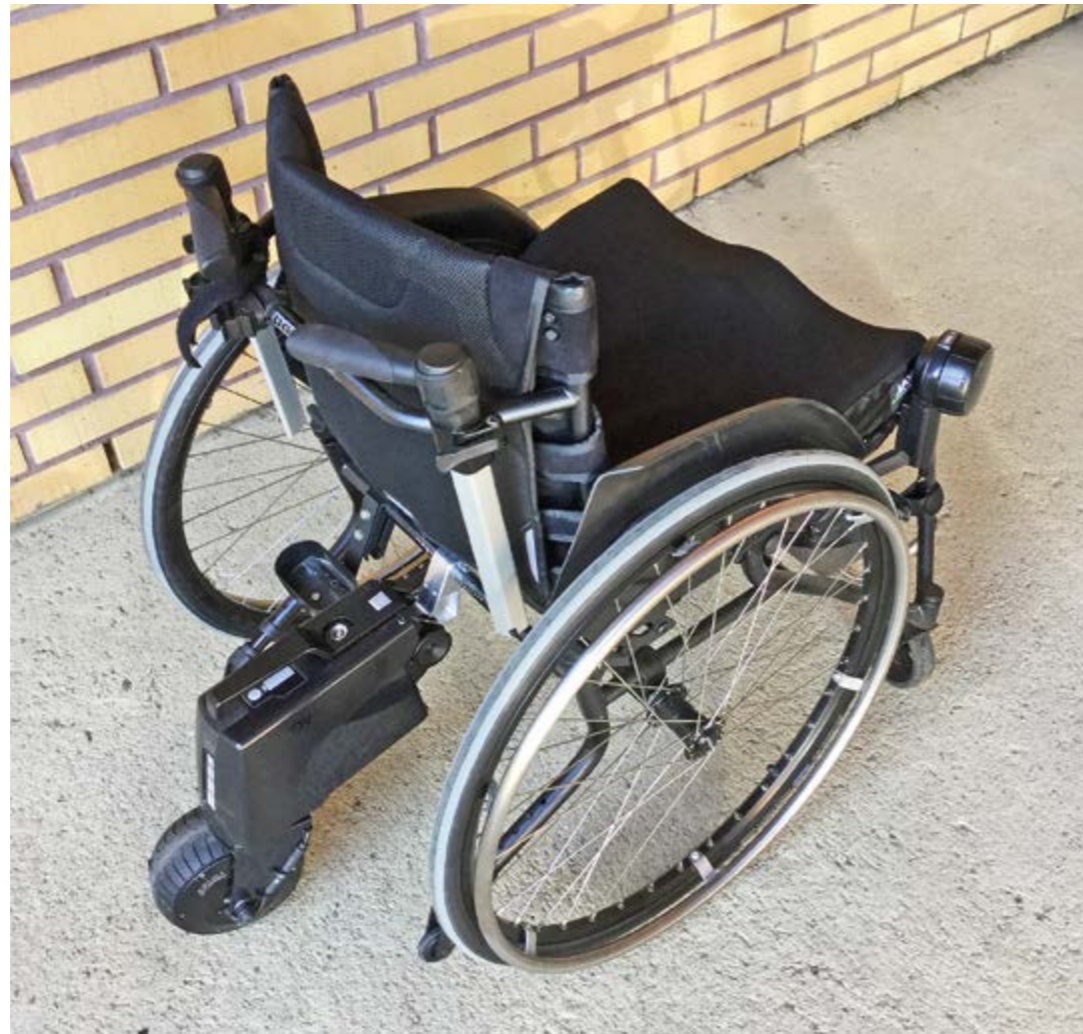
Manuaalipyörätuoliin on mahdollista liittää monenlaisia kelaamista tukevia apuvälineitä. Tässä ns. ”takatuupparimalli”. Lisälaite on helposti liitettävissä ja irrotettavissa. Sen avulla kelaus kevenee huomattavasti ja näin onnistuvat pitkätkin matkat ilman kohtuutonta itsensä rasittamista.
