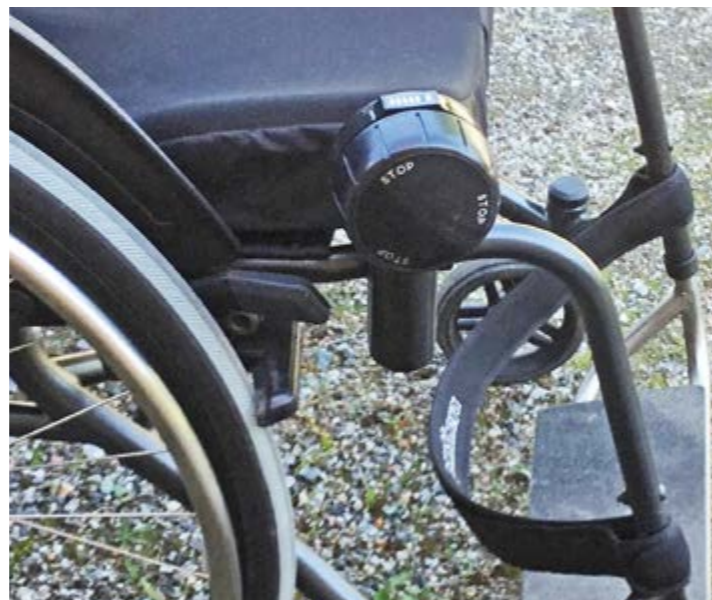
Manuaalipyörätuoliin on mahdollista liittää monenlaisia kelaamista tukevia apuvälineitä. Tässä ns. ”takatuupparimalli”. Lisälaite on helposti liitettävissä ja irrotettavissa. Sen avulla kelaus kevenee huomattavasti ja näin onnistuvat pitkätkin matkat ilman kohtuutonta itsensä rasittamista.
